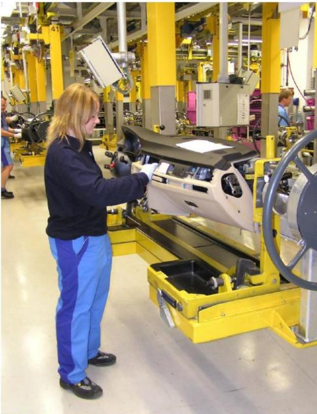
Beispiel: Montage eines Cockpitmoduls im
