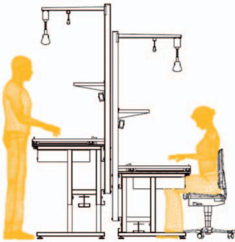
Rund 16.000 PCs, Notebooks und Server verlassen täglich die hochmoderne Fertigung von Fujitsu in Augsburg. Bei der Neugestaltung einer PC-Montagelinie wurde in die Tische eine Hubeinrichtung integriert, die es per Fußschalter ermöglicht, den Werkstückträger anzuheben, um den PC für die einzelnen Montageschritte um 360° drehen zu können.
