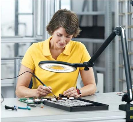
ESD-Schäden an elektronischen Bauteilen sind ein ernst zu nehmendes Problem. Schutzzonen und speziell eingerichtete Arbeitsplätze sind daher ein wichtiger Schritt, um Beschädigungen zu vermeiden. Deshalb bietet Waldmann seine ergonomischen LED-Arbeitsplatzleuchten auch als ESD-sichere Varianten an.
